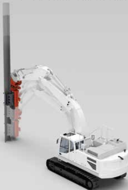
Movimento vertical com a escavadeira estacionária.
